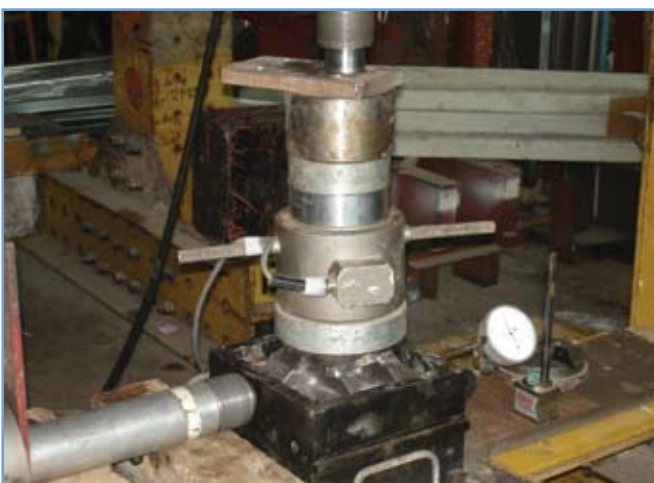
3. ábra: Szálerősítés hatásának vizsgálata közvetlen nyírókísérlettel
