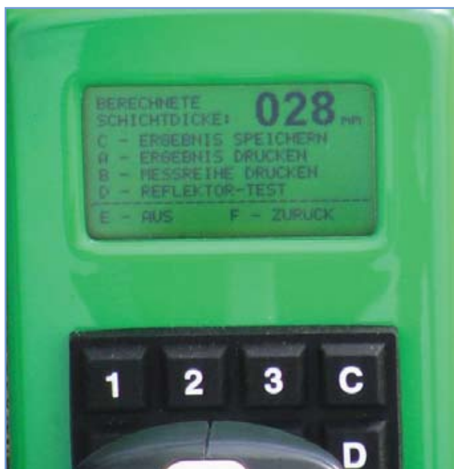
3. ábra: A mért aszfaltvastagság megjelenítése a kijelzőn
