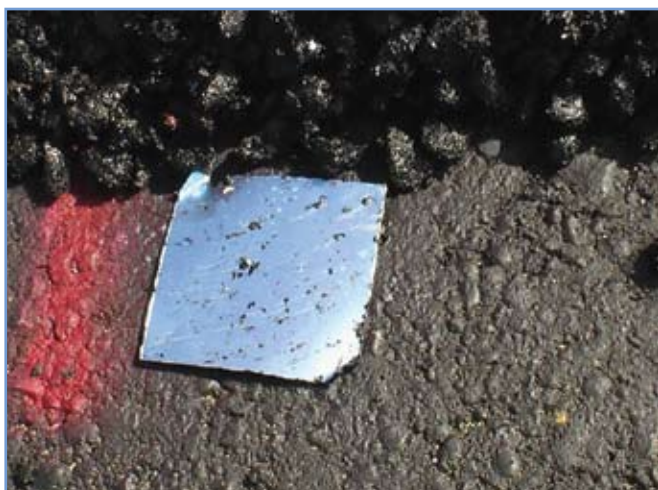
1. ábra: A mérendő aszfaltréteg alá elhelyezett antipólus
