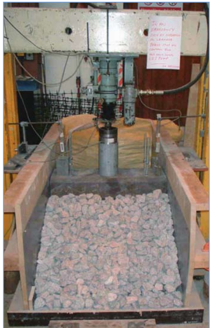
5. ábra: Ágyazatváll lefolyását modellező laborkísérlet [4]
