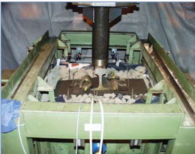
4. ábra: Teljes magasságú oldalfalú terhelődoboz triaxiális vizsgálatnál [7]
