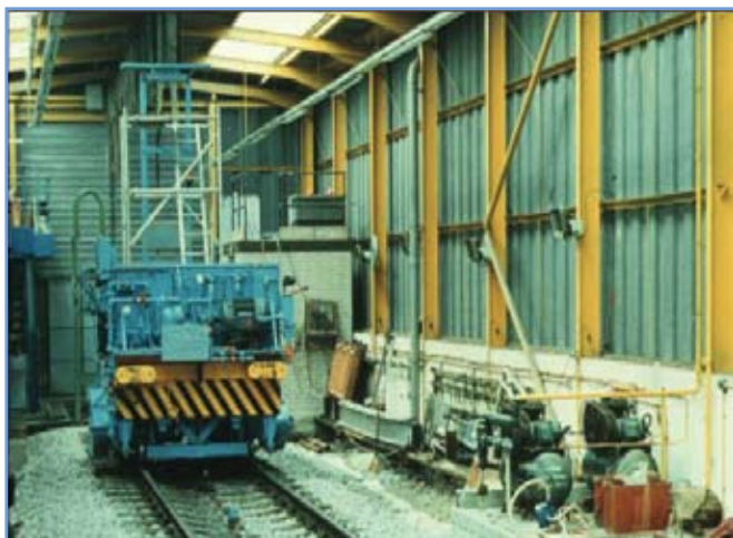
2. ábra: Valós méretű vágánydarab laboratóriumi elrendezése [10]
