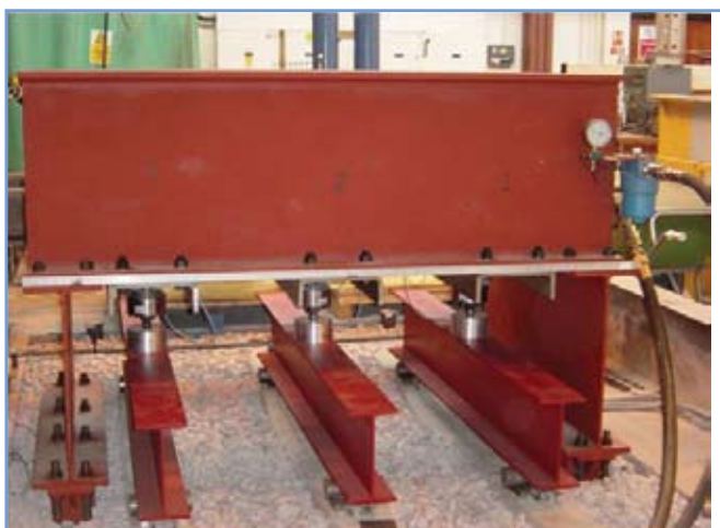
3. ábra: Pulzáló terhelés alkalmazása valós vasbeton keresztaljakkal és terhelőgerendával [18]
