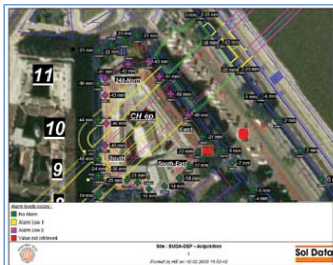
3. ábra: A süllyedés monitoring internet platform nyomtatott oldala, a Budapesti Műszaki és Gazdaságtudományi Egyetem CH épületének megjelenítésével (Geoscope Web, SolData-Hungeod)
