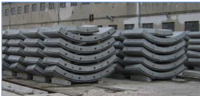
3. ábra: Tübbingelemek a gyártó telephelyén, gyűrűként rakatolva. A bal oldalon speciális gyűrűelemek, oldalukon jól láthatók a műanyag csapok helyei. A kisebb lyukak a gyűrűszereléshez szükséges rögzítő csavarok helyei
