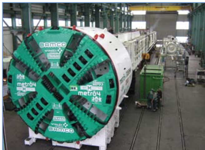
1. ábra: A pajzs szerelése a schwannai gyár csarnokában
