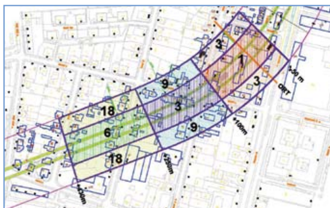
4. ábra: Manuális süllyedésmérések gyakorisága a pajzstól mért távolság függvényében (dinamikus maszk)
