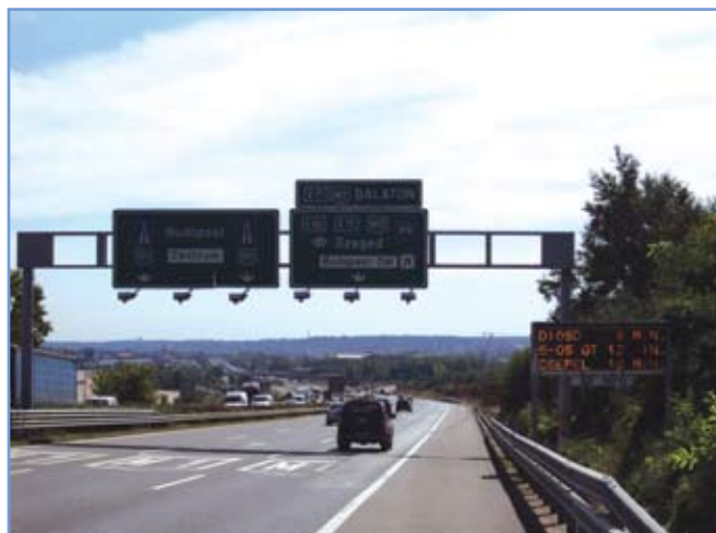
6. ábra: VUK rendszer kijelzője (M1 autópálya 17 km)
