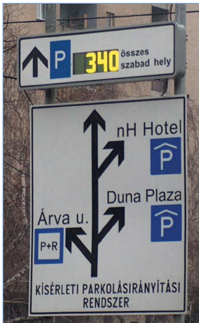
2. ábra: A Budapest XIII. kerületében telepített kísérleti parkolási-irányítási rendszer gyűjtőtáblája a Váci út – Árpád út csomópontban
