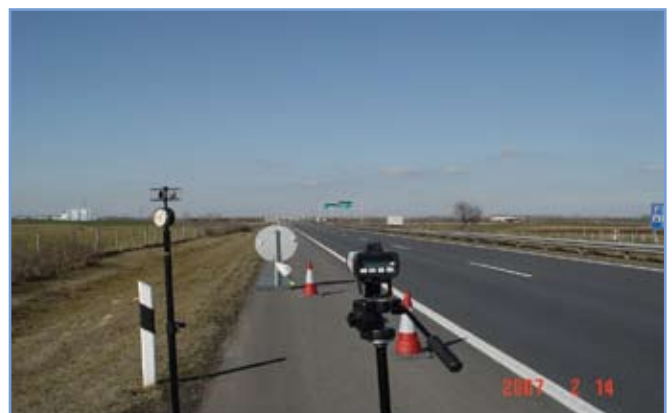
1. ábra: Pass by mérés – sebességmérés, meteorológiai mérés
