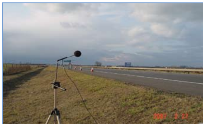
2. ábra: Pass by mérés – zajvizsgálat
