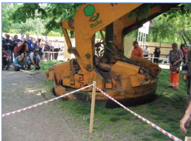
1. ábra: Élő fa kiemelése az átültető célgép segítségével
