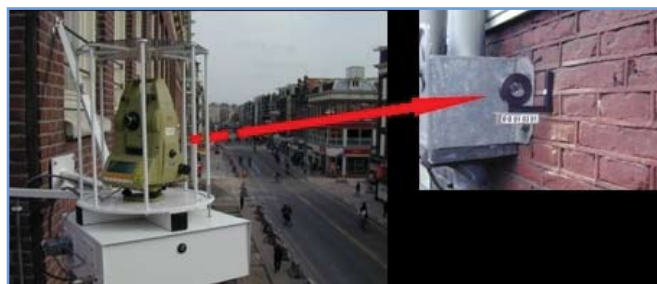
2. ábra: Az automata mérések működési elve (Forrás: Sol Data–Hungeod)
