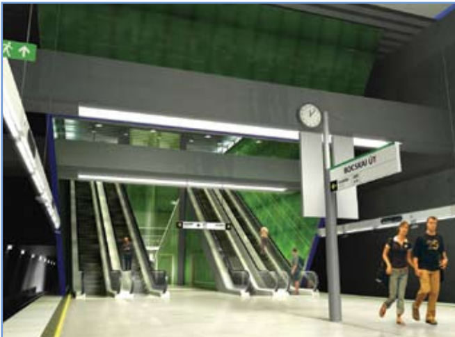
5. ábra: A felszíni terület szűkössége miatt a Bocskai út állomás mozgólépcsőcsoportja a peron végére került
