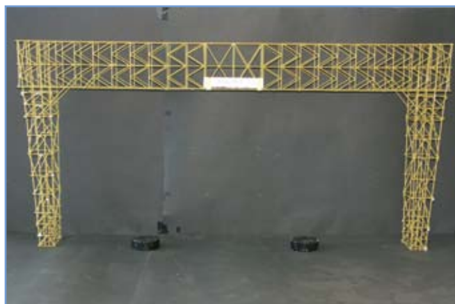
13. ábra: Egy keret 2007-ből, ami 12 kg-ot birt el (Forrás: http://mechanika.ymmf.hu/ )
