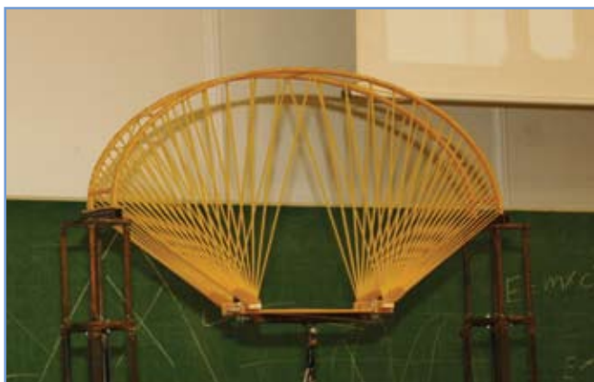
15. ábra: A Győrei–Czipó-páros két ponton terhelt hídja (Forrás: Győri Kredit)
