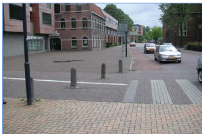
4. ábra: Torenstraat csomópont-becsatlakozás gyalogátkelőhellyel és kerékpársával
