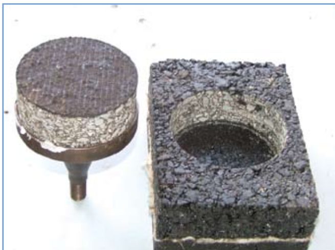
4. ábra: GR-G100 háló feltépvizsgálat után
