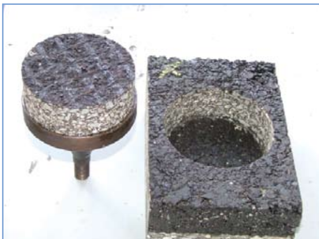
5. ábra: S&P Glasphalt G háló feltépvizsgálat után
