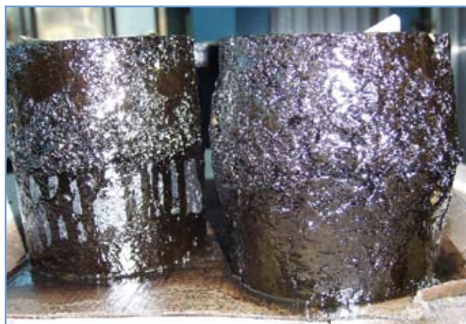
23. ábra: „Kihasasodott” próbatetek vizsgálat után
