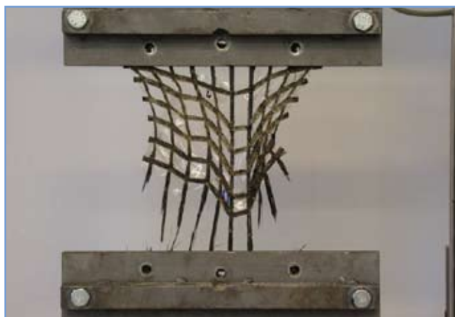
20. ábra: A 4. sz. minta tönkremenetele
