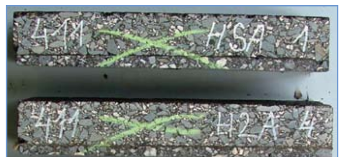
6. ábra: A hajlításvizsgálathoz készült próbatestek (1. és 2. vizsgálati csoport)
