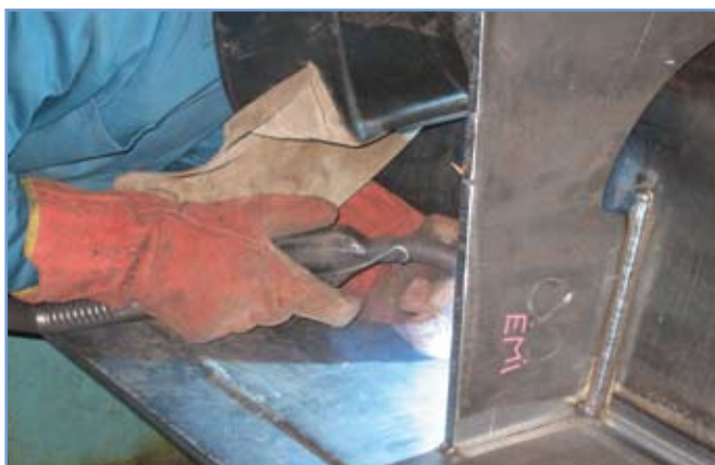
1. ábra: Gyártásközi hegesztési próba készítése
