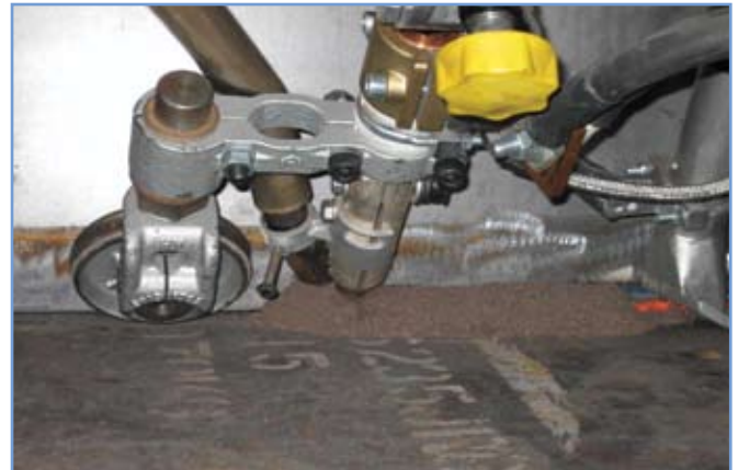
5. ábra: Trapézborda nyakvarrat hegesztése fedett ível
