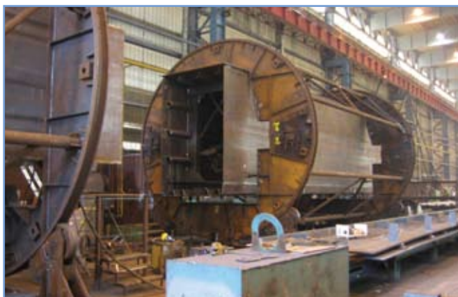
2. ábra: Merevítőtartó szekrényeinek hegesztése forgatópadban
