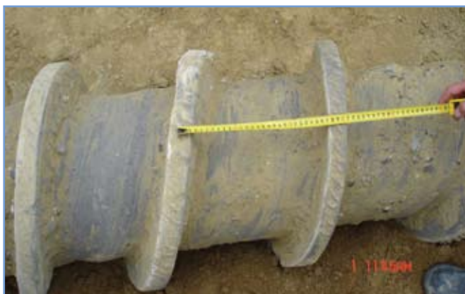
4. ábra: Kiásott cölöp spirálokkal
