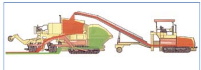
6. ábra: A speciális finiser alapanyaggal történő ellátásának szemléltető ábrája
