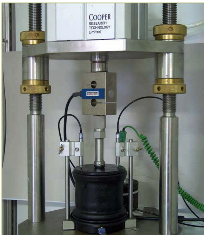
2. ábra. A vákuum triaxiális vizsgálat elrendezése (MSZ EN 12697-25) (a szerző felvétele)
