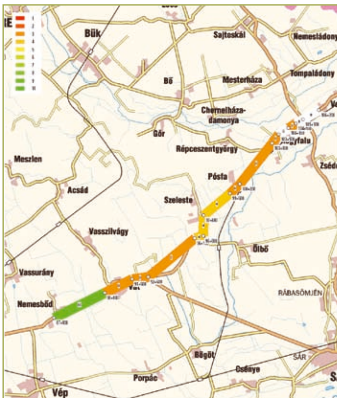
5. ábra - A forgalomtechnikai jelzések megfelelésége a 86. sz. főút 87+000 – 106+200 km szelvények közötti szakaszán (1 – legkedvezőtlenebb érték, 10 – legkedvezőbb érték)
