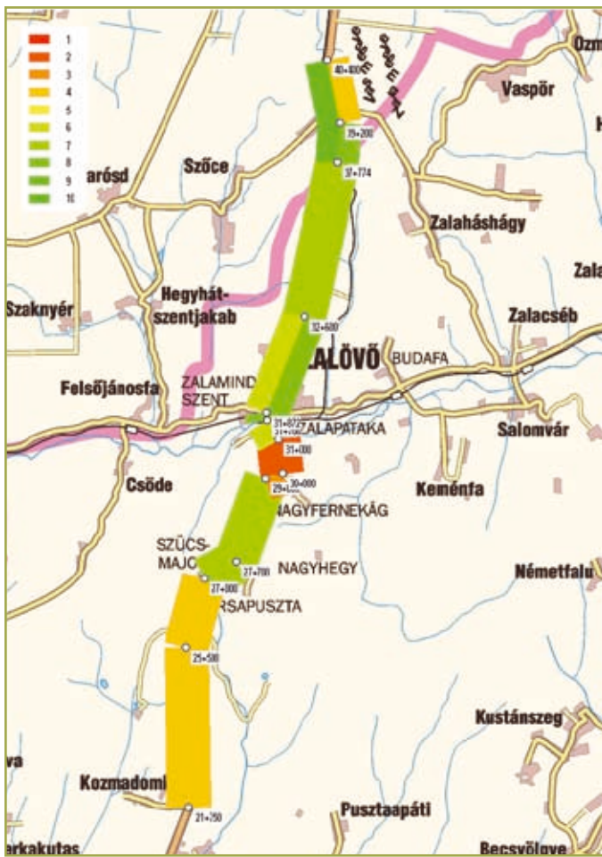
4. ábra – A 86. sz. főút 21+750 – 40+400 km szelvények közötti szakaszának függőleges vonalvezetése (szelvényezés szerinti bal oldal) és vízszintes vonalvezetése (szelvényezés szerinti jobb oldal) (1 – legkedvezőtlenebb érték, 10 – legkedvezőbb érték)
