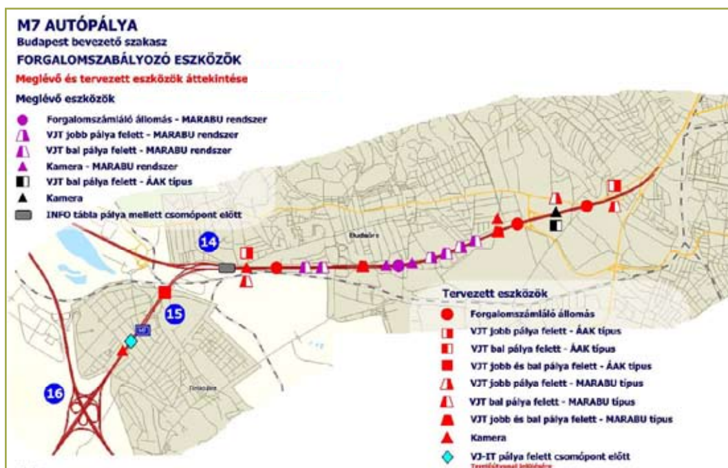
3. ábra: A meglévő és a javasolt forgalomszabályozó eszközök az M7 autópálya Budapest – M0 autópálya közötti szakaszára
