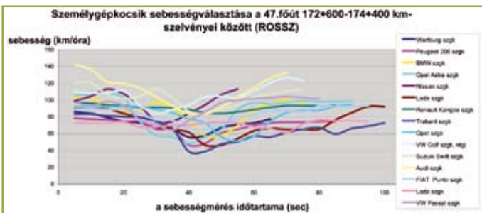
1. ábra.: Személygépkocsik sebességválasztása a 47.főút 172+600-174+400 km-szelvényei között (ROSSZ)
