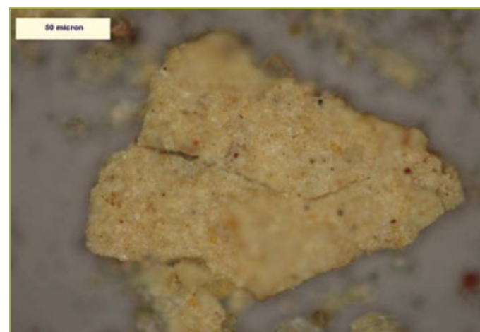
5. ábra: Proctor-minta lemezes szemcséjének mikroszkopikus felvétele
