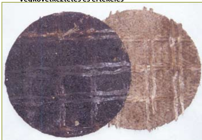
4. ábra: A kompozit állapota a terhelés után
