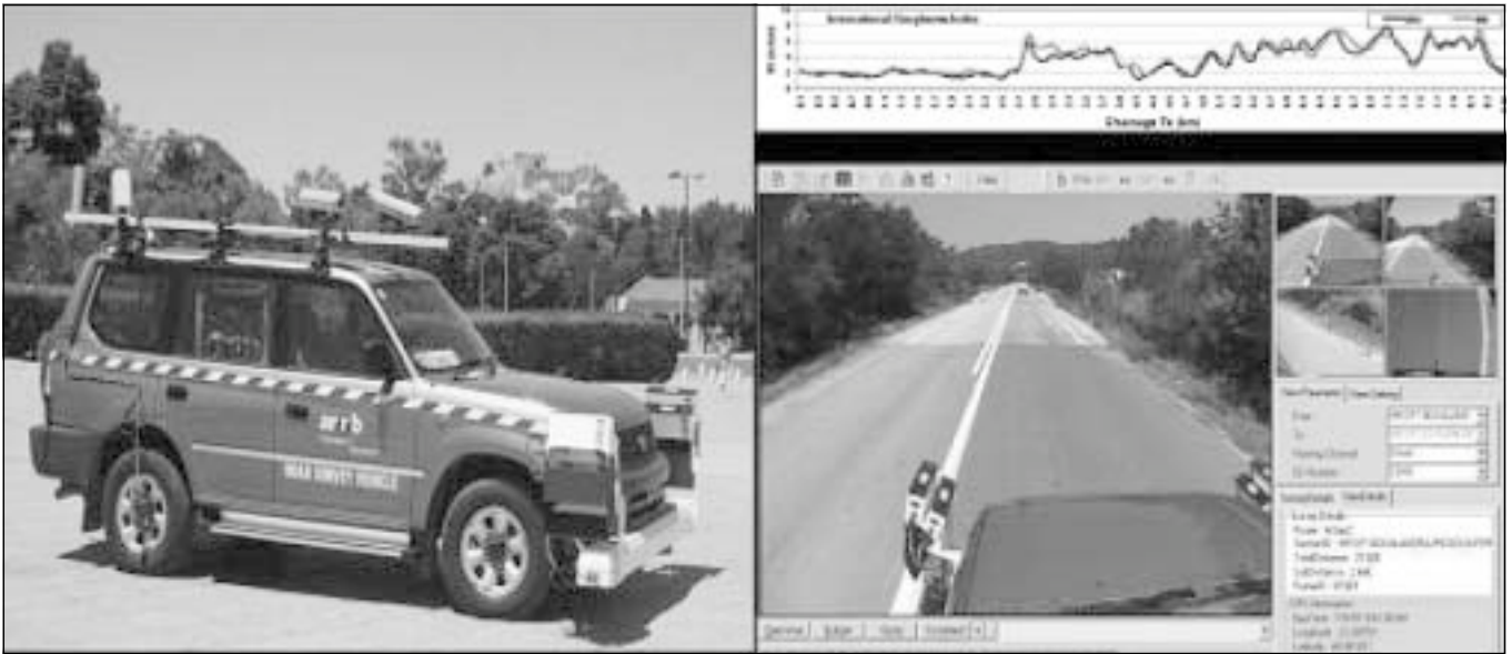
4. ábra: Az ARRB hálózatvizsgáló jármű és a szakaszonkénti állapotadatok bemutatása diagramok és képek integrálásával [Roberts et al., 2003]
