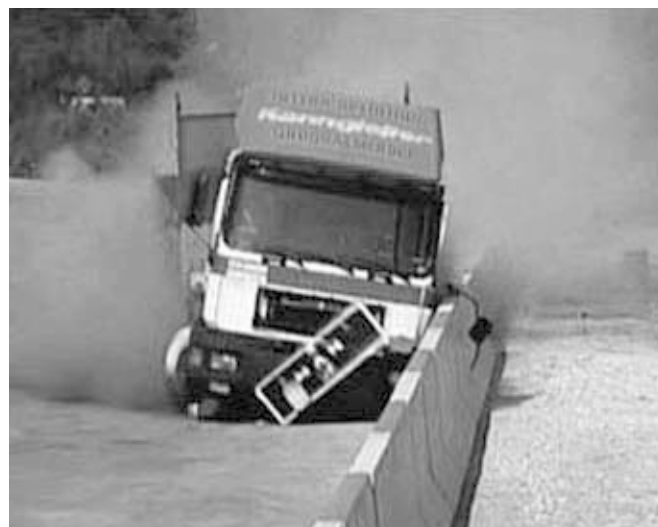
4. ábra: Az ütközésvizsgálat pillanata
