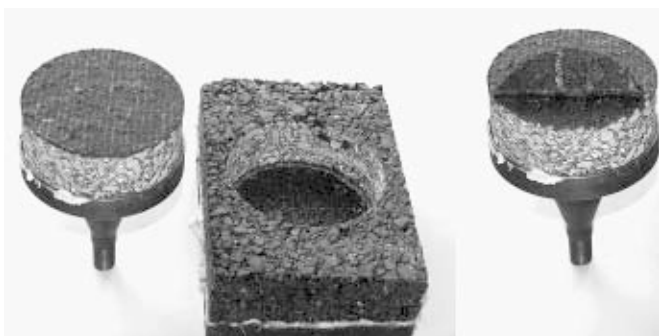
11. ábra: Roadtex GR-G100 háló feltépés vizsgálat után, jobbra a háló felhajtva
