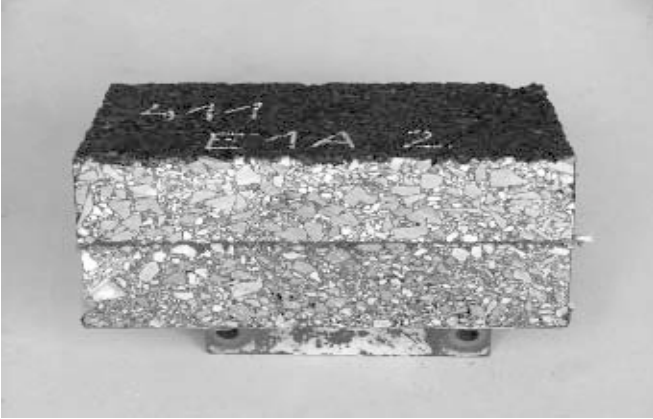
5. ábra: Az elcsúszás vizsgálathoz készített próbatestet
