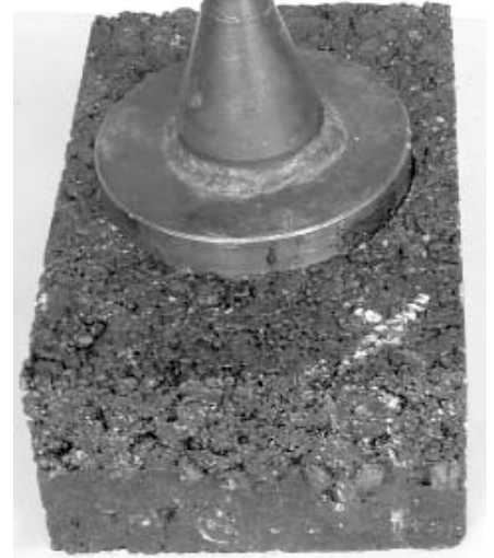
9. ábra: Feltépéshez előkészített próbatest
