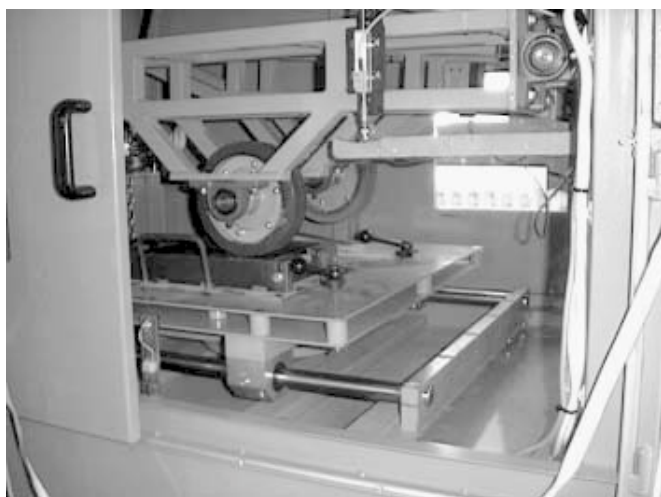
14. ábra: AKV-típusú keréknyom-képződést vizsgáló gép
