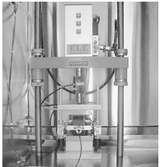
6. ábra: Az ELE Univerzális aszfaltvizsgáló berendezés
