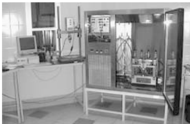
9. ábra: Négy pontos gerendafásasztó vizsgálati összeállítás
