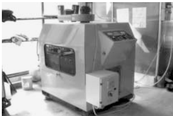
15. ábra: LCPC típusú keréknyomképződés vizsgáló gép
