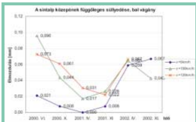
3. ábra: A sín talpának a keresztaljhoz viszonyított relatív függőleges elmozdulásainak az átlaga az egyes mérési időszakokban V = 5, 100 és 120 km/h sebességnél
