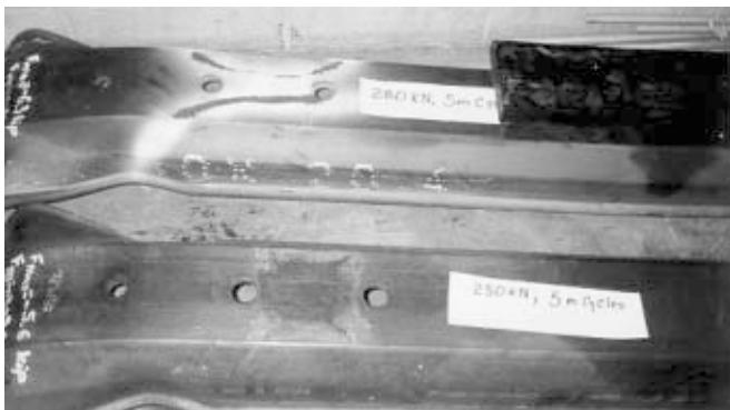
9. ábra: Repedés kialakulása a fárasztóvizsgálat végén ( F_{\max} = 280 \text{ kN} , F_{\min} = 28 \text{ kN} , f_1 = 3 \text{ Hz} , f_2 = 7 \text{ Hz} , n = 5 \cdot 10^6 )
