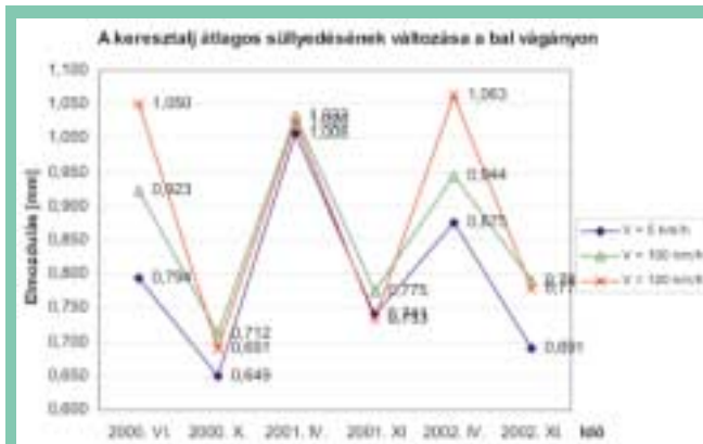
4. ábra: A keresztalj abszolút függőleges elmozdulásainak az átlaga az egyes mérési időszakokban V = 5, 100 és 120 km/h sebességnél
