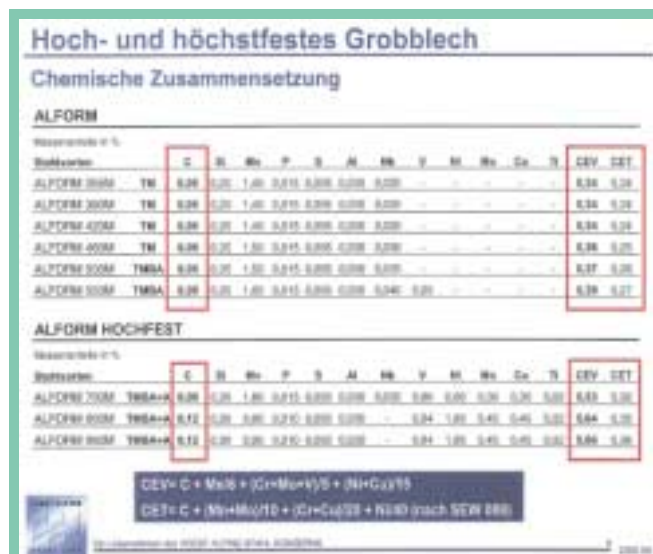
20. kép: A termomechanikus hengerléssel gyártott különféle nagyszilárdságú acélok vegyi összetétele. Különös figyelmet érdemel a C tartalom és a CEV rendkívül kedvező, alacsony értéke
