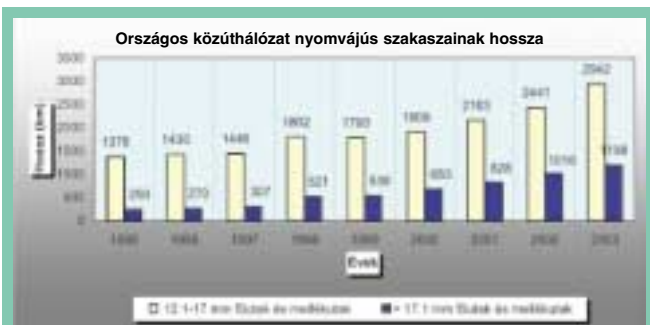
12. ábra: Az országos közúthálózat megoszlása a nyomvályú mért értéke szerint
