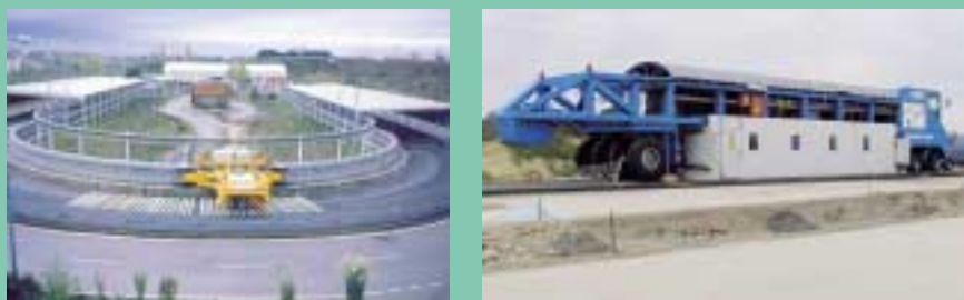
1. ábra: A spanyol CEDEX kutatóintézet körpályás vizsgálóüzeme és a Heavy Vehicle Simulator HVS-NORDIC
