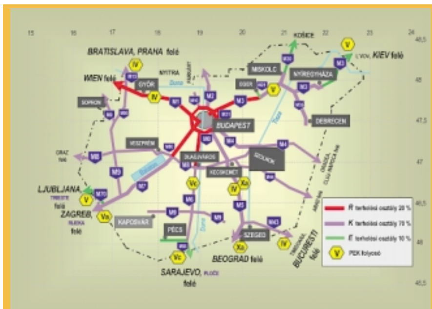
1. ábra: A 2044/2003 Korm. sz. határozat szerint 2015-ben üzemben lévő gyorsforgalmi úthálózat vonalainak forgalmi terhelési osztályai
